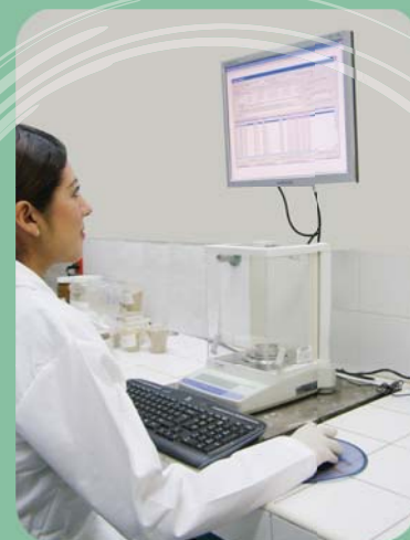
Cuarto de pesaje de alta precisión con ambiente controlado
